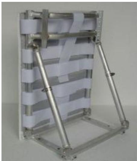
Esta é a 3ª geração de "design" do nosso suporte de tronco. É ajustável em relação ao ângulo e altura do tronco. Existem 4 larguras disponíveis (220mm, 260mm, 340mm, 380mm). Todas as partes podem ser intercambiáveis dentro dos 4 tamanhos, exceto a parte superior e a almofada.
