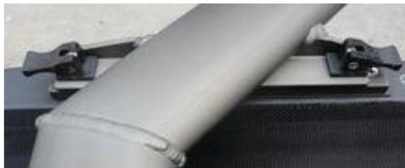
O kit de Soltura Rápida (SR) tem a mesma altura dos espaçadores de 10mm, então quando o kit SR é usado, se tem 10mm menos de ajuste de altura.
