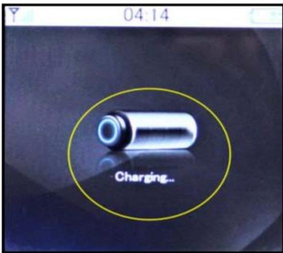
2. O ícone de carregamento será exibido quando a unidade estiver carregando (também pode dizer USB conectado quando conectado a um computador).
