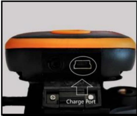
1. Entrada USB para conexão com computador.
