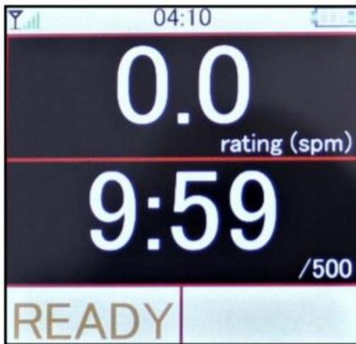
13. Visor (Display) de 2 + 2 Variáveis: Voga / Velocidade alternam a cada remada com Tempo / Distância - observe o painel inferior esquerdo para controlar o cronômetro e a gravação
